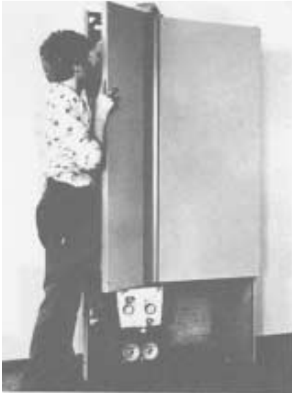
Fig. 16. Frontlåg monteres og rettes op i hængslet (aflange huller). Isolering på VV-beholderens topflange lægges på. Kabinettets topplade monteres (Nøglehuls-udsparringer).
